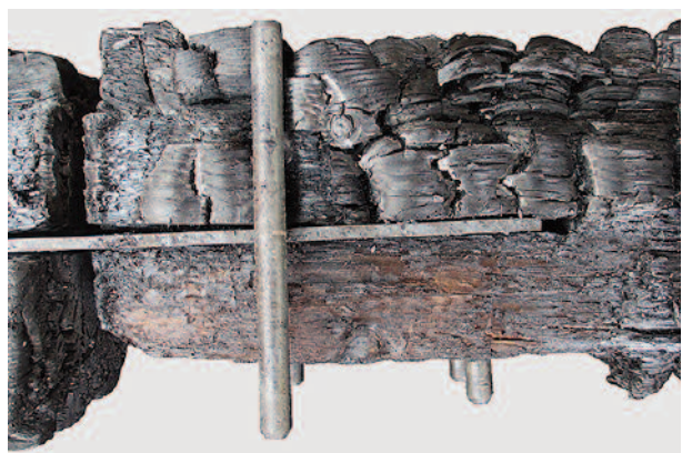
Mit Vollgewindeschrauben verstärkte Stahl-Holz-Stabdübelverbindung nach einem Feuerwiderstandsprüfung. Steel-to-timber dowelled connection reinforced with screws after a fire resistance test.
