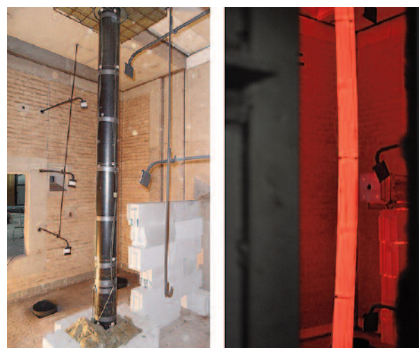
Prüfkörper Nr. 2 (links) vor Versuch, Prüfkörper Nr. 1 (rechts) nach Versuch. Specimen No. 2 (left) before the fire test, Specimen No. 1 (right) after the fire test.
