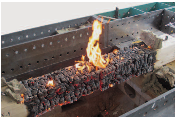
Versuchskörper am Ende des Brandversuches auf dem kleinen Ofen an der Empa. Test specimen after the fire test on the small furnace at Empa.
