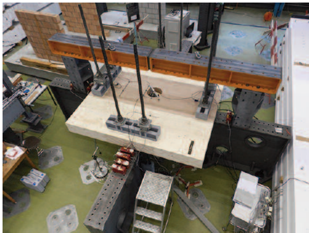
Versuchseinrichtung für die experimentellen Untersuchungen zum Tragverhalten von Stützenkopfplatten.
