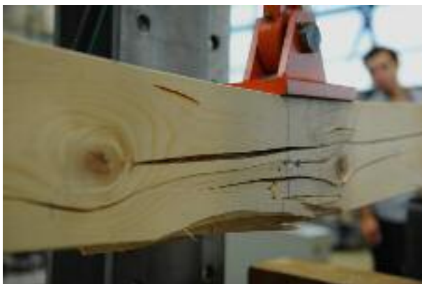
Vierpunkt Biegeprüfung an einem Kantholz.
