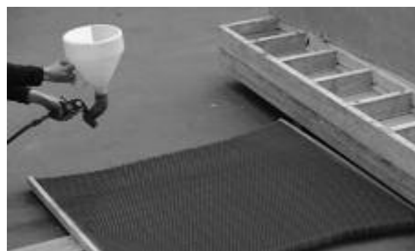
Beschichtung von grossmassstäblichen Wabenkartonplatten mit einer Sprühpistole. Coating of large scale honeycomb boards using an airgun.
