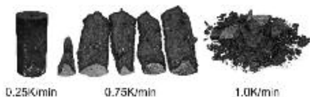
Explosives Abplatzen eines hochfesten Betonzylinders bei unterschiedlichen Aufheizgeschwindigkeiten (0.5 - 0.75 - 1.0 K/min). Explosive spalling of a high-strength concrete cylinder heated with different heating rates (0.5 - 0.75 - 1.0 K/min).
