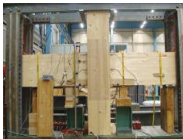
Experimentelle Untersuchungen zum Tragverhalten des vorgespannten Träger-Stütze-Knotenanschlusses. Experimental analysis of the structural behaviour of the post-tensioned beam-column timber joint.
