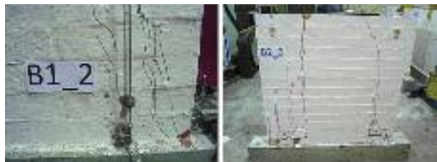
Druckbruch der Körper B1_2 und B2_3. Compression failure: specimens B1_2 and B2_3.
