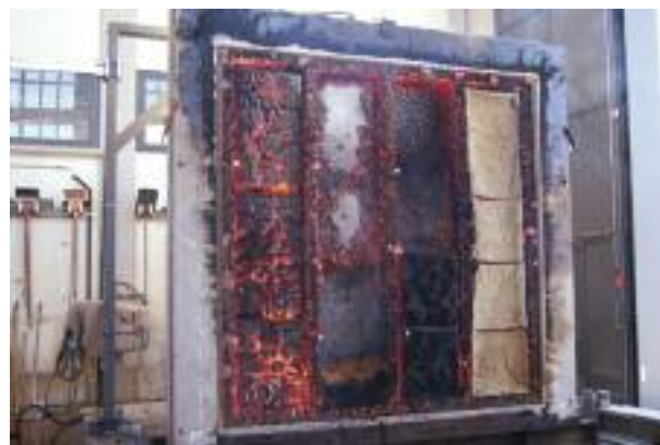
Brandversuch an einer Holzrahmen-Wandkonstruktion mit unterschiedlichen Dämmungen. Fire test on a light timber frame wall assembly filled with different insulation materials.
