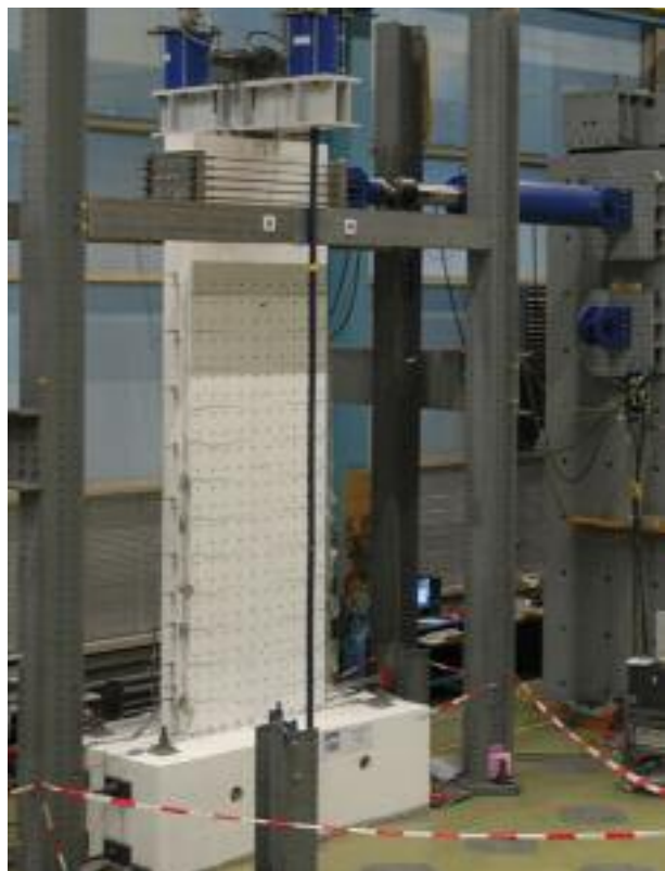
Resultate und Einrichtung der Brückenstützenversuche. Results and test setup of the bridge pier tests.
