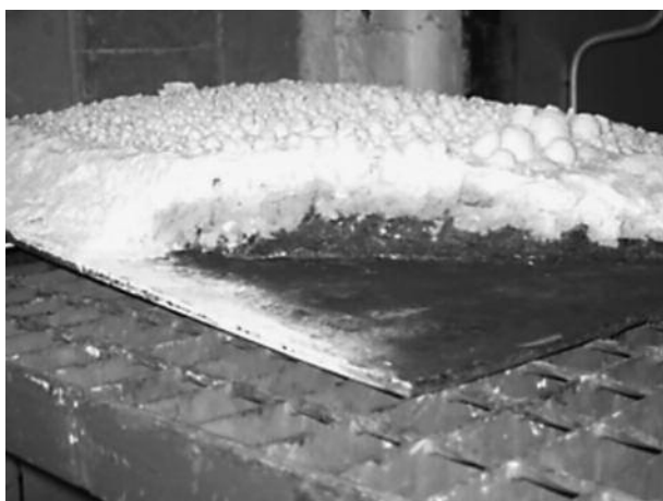
Aufgeschäumter Brandschutzanstrich nach einem Brandversuch. Expanded intumescent coating after a fire test.
