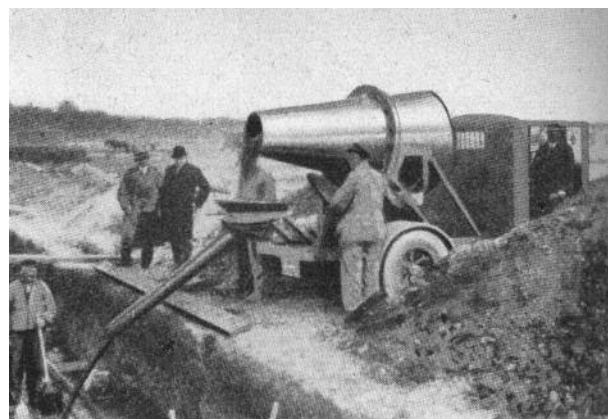
Dänisches Betonmischfahrzeug aus den 1930er Jahren [2]. Danish ready-mixed concrete lorry of the 1930s [2].
