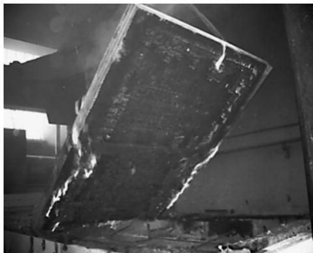
Brettsperrholzplatte nach dem Brandversuch. Cross-laminated solid timber panel after the fire test.
