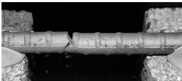
Infolge Ermüdung gebrochener Bewehrungsstab. Fractured reinforcing bar due to fatigue failure
