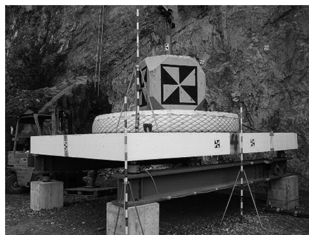
Steinschlagversuche auf dem WSL-Versuchsgelände. Rockfall experiment at WSL's test site.
