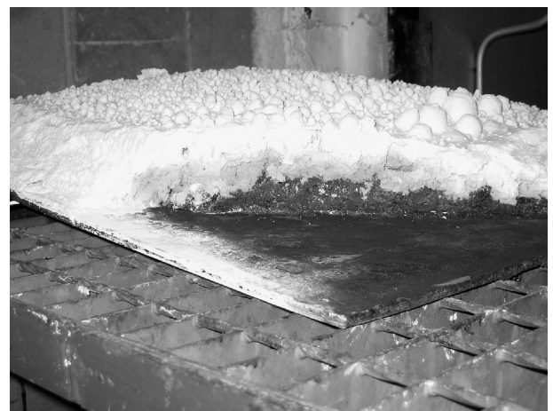
Aufgeschäumter Brandschutzanstrich nach einem Brandversuch.
