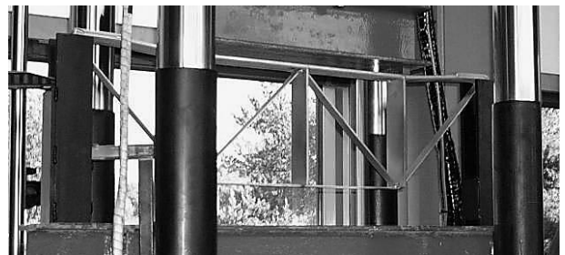
Die Metallbrücke während der Belastung.
