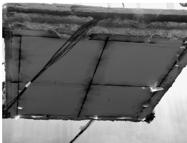
Brandversuch mit Gipsplatten. Fire test with gypsum plasterboard.
