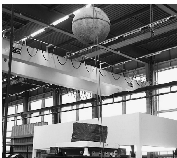
Vorversuch mit Fallkörper. Preliminary falling weight test.
