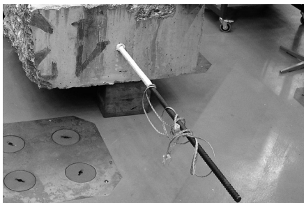
In Probekörper eingemörtelter Bewehrungsstab vor dem Versuch. Post-installed rebar prior to testing.
