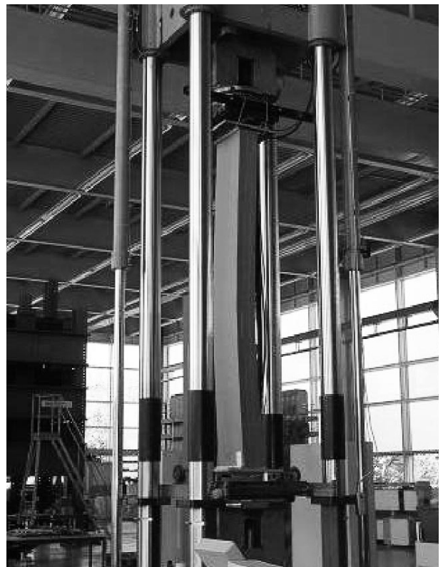
Knickversuch an einem Wabenkarton-Testkörper. Buckling test on a honeycomb cardboard sample.
