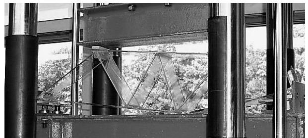
Die Glasbrücke nach dem Bruch.
