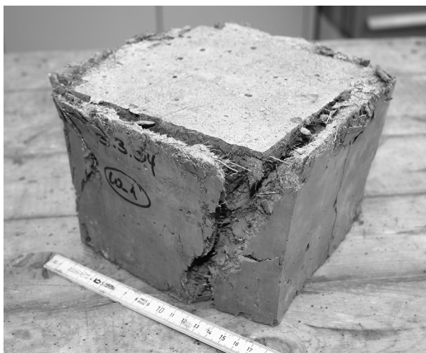
Prüfkörper aus HFC nach einem Druckversuch. HFC specimen after a compression test.
