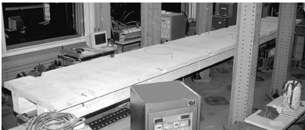
Vorgespanntes Holz-Beton-Verbund-Deckenelement. Prestressed timber-concrete composite beam.
