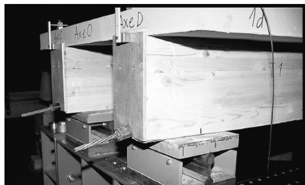
Detail: Stirnplatte zur Übertragung der Vorspannkräfte zwischen Spannglied und Holzträger. Detail: Steel plate for the load transfer between prestressing tendon and timber beam.
