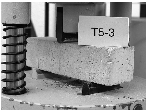
Biegezugversuch eines Mörtelprüfkörpers.
