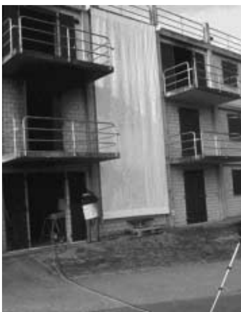
Gewebepanzen für Brandversuch am Übungsgebäude. Textile cover for large scale fire test.
