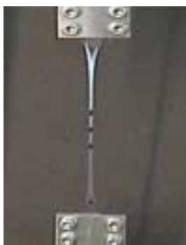
Zugversuch einer PVB Probe. Tensile test of a PVB plastic film.
