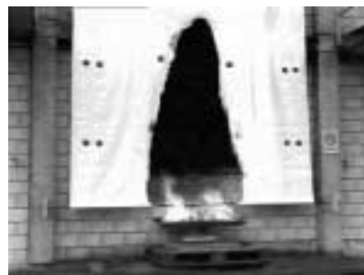
Brandversuch an schwerentflammbarer Verkleidung nach 180 Sekunden.
