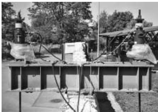
Krafteinleitung mittels Querjoch und Hydraulikpressen.
