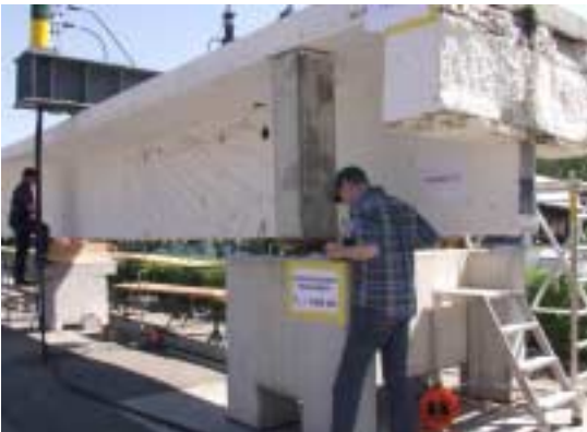
Dieser Brückenträger wurde bis zur Zerstörung belastet.
