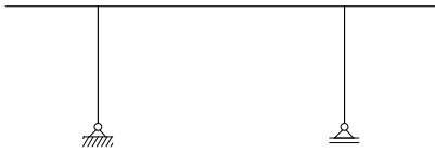
Bild 1: Lagerung als einfacher Balken
